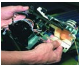
Werfen wir einen Blick in die Fertigung des Ektapros: Das Herzstück bildet die Fallschachteinheit mit Diabühne und Objektivträger, die auf einem soliden Druckgussteil aus Aluminium montiert ist. Im Fallschacht werden die Dias in drei Ebenen auf ein hundertstel Millimeter genau positioniert.
