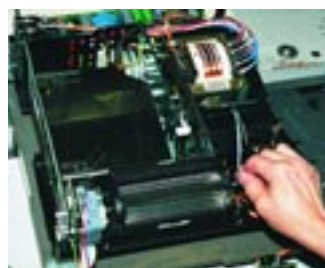
Im noch offenen Projektorgehäuse ist vorn der große Lüfter zu erkennen, der für die optimale Kühlung der Dias zuständig ist. Rechts oben befindet sich der Trafo, der den Strom für die 300-W-Lampe liefert. Die große Hauptplatine liegt ganz unten im Gehäuse und ist hier nicht sichtbar.
