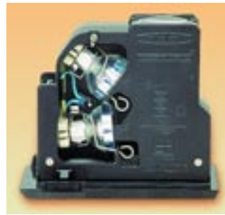
Die Kaltlichtspiegellampe und der Umlenkspiegel im Lampenmodul reflektieren kaum Wärmestrahlung, sondern führen sie über das Gehäuse ab. Für spezielle Anwendungen kann in das Modul ein zusätzlicher Wärmeschutzfilter eingesetzt werden. Die Lebensdauer der Lampen ist mit 35 Stunden angegeben, was aber im Überblendbetrieb nicht erreicht wird. Es gibt auch Typen mit längerer Lebensdauer, die allerdings auch weniger Licht liefern. Fällt eine Lampe aus, wird automatisch auf die zweite umgeschaltet.
